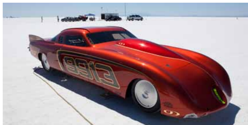
Bonneville ligt op ruim 2100 meter hoogte. Voordeel: de dunne lucht zorgt voor minder weerstand. Nadeel: je moet de motor voorzien van een turbo om het verlies aan pk's te compenseren.
