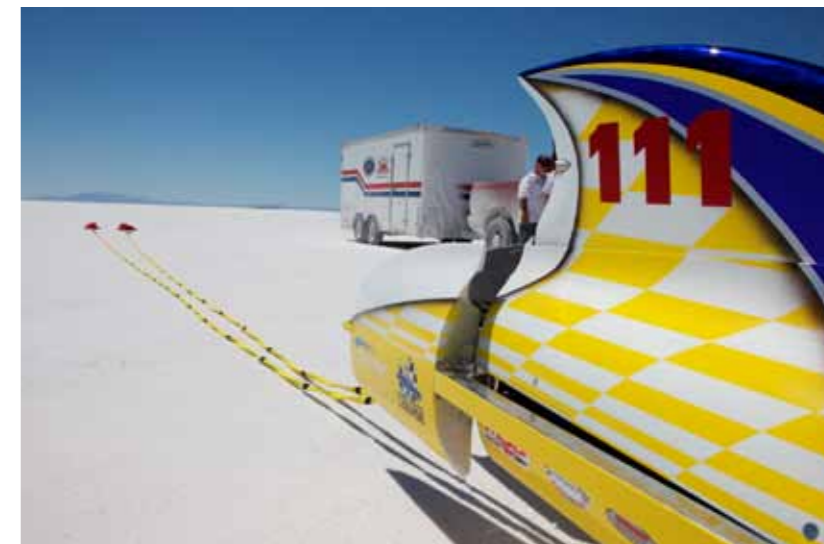
Remmen is verboden op Bonneville. De weerstand die dat met zich meebrengt zou het zout binnen no time kapot scheuren. Elke auto heeft daarom een remparachute.
