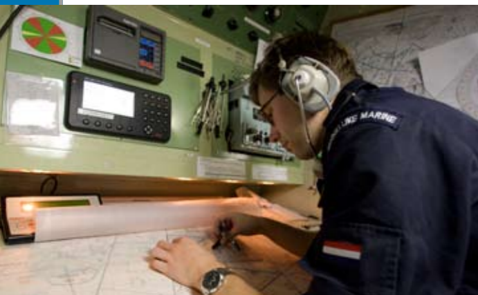
Gps werkt niet onder water. Een kompas wel. Dus zet je je koers met een gradenboog uit op een kaart.
