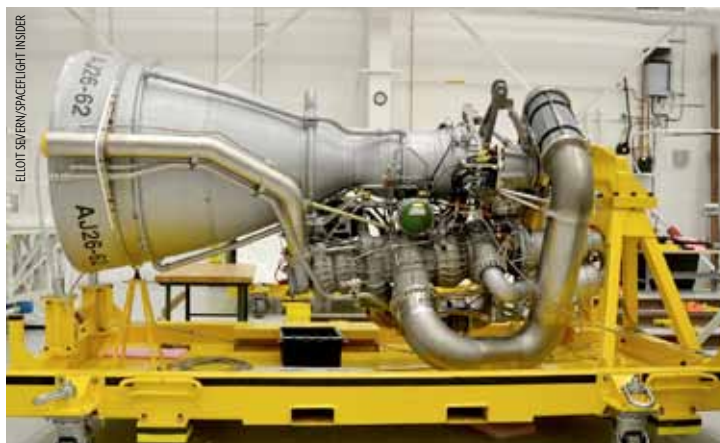
In de jaren zestig was de NK-33 de meest geavanceerde raketmotor ooit. Orbital bouwde de motor om en gaf hem een nieuw typenummer (AJ-26-b), maar na de mislukte lancering van Antares in 2014 gaat het bedrijf op zoek naar een vervanger.
