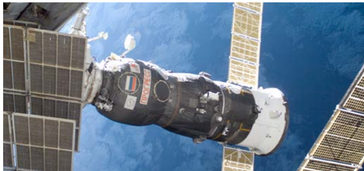
Het Europese Automated Transfer Vehicle (boven) of het Russische vrachtschip Progress (onder) moeten het ISS tijdens de de-orbit afremmen, zodat het station terugvalt naar de aarde.
